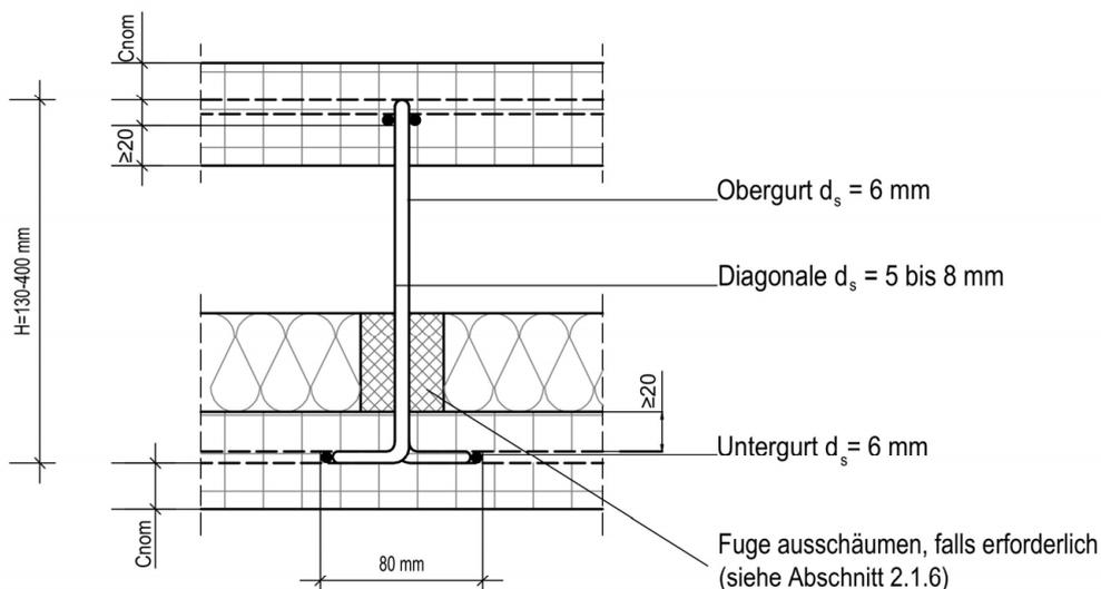
Betonstahlsorten analog Anlage 1, Seite 1
