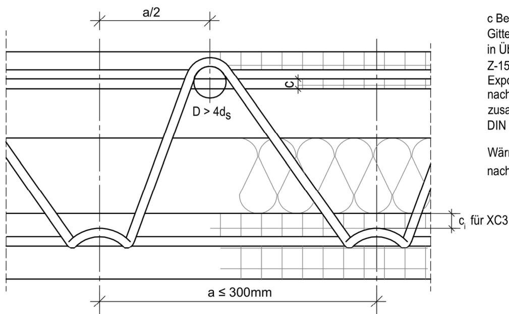
c Betondeckung der Gitterträger nach innen in Übereinstimmung mit Z-15.2-40 und für Expositionsklasse XC3 nach DIN EN1992-1-1 zusammen mit DIN EN 1992-1-1/NA
