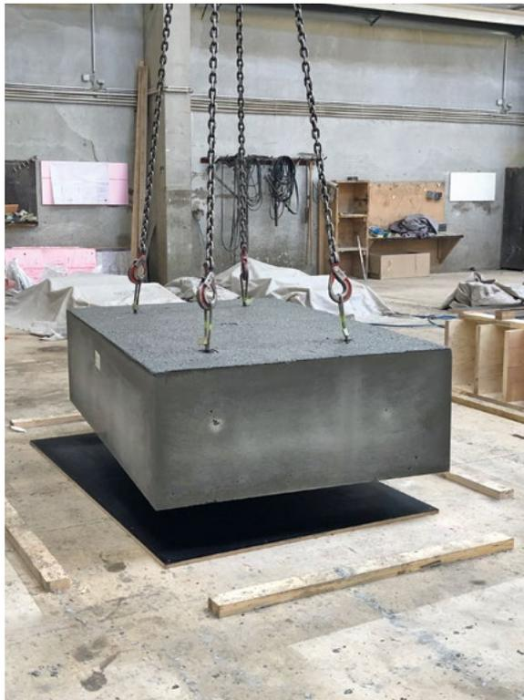
Prüfplatte zur Untersuchung der Frühfestigkeit von ILC.
