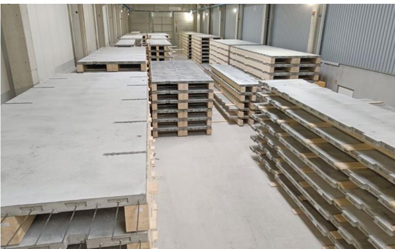
Lagerung der fertigen HB-Verbunddecken.
