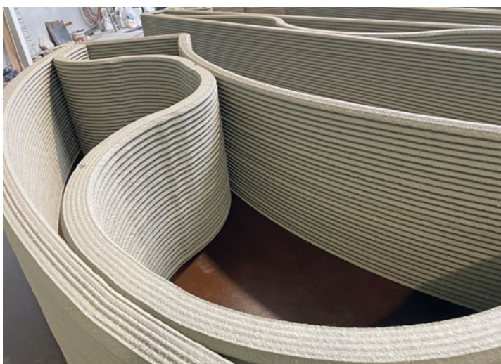
Herstellung der Sitzelemente mit dem 3D-Betondrucker im Werk.
