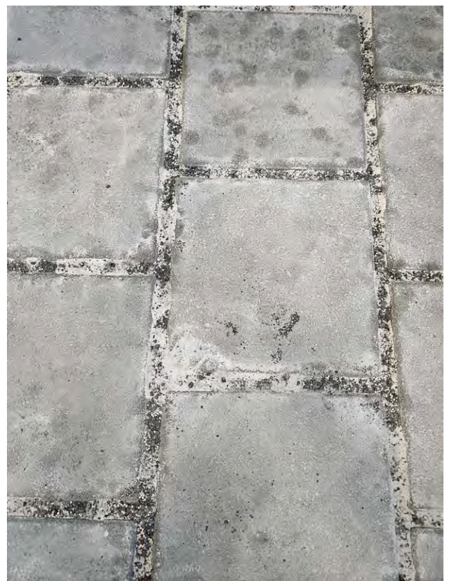
Test eines Fugenmaterials zur Bestimmung der Versickerungsleistung und Filtration von Schadstoffen.
