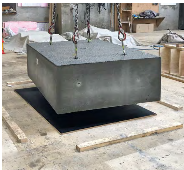
Prüfplatte zur Untersuchung der Frühfestigkeit von Infralichtbeton.
