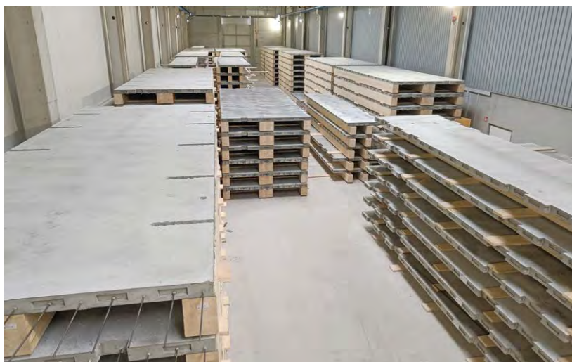
Lagerung der fertigen HB-Verbunddecken.
