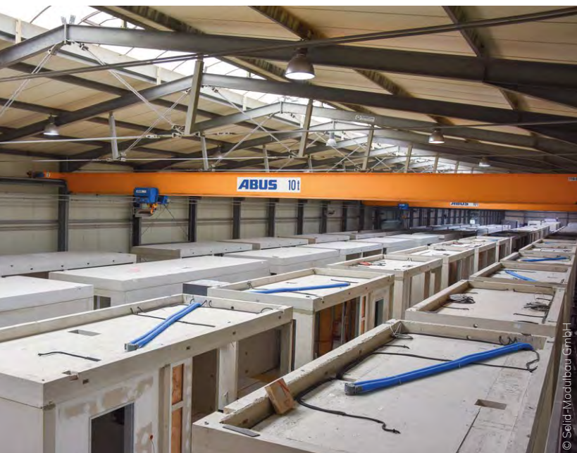
Seriell vorgefertigte Module im Werk.
