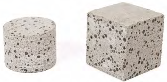
Infraleichtbeton-Proben – Rezeptur mit Blähton und Blähglas.
