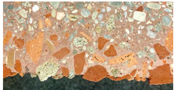
Bild 8b: RC-Material (Ziegelbruch) als Fassade und im Querschnitt einer Vorsatzschale, Laumer Bautechnik.
