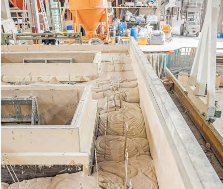
Bild 6: Neuartige Fassadenbauteile mit Mineralschaumdämmung, Zuber Beton.
