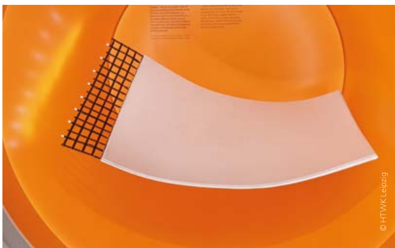
Bild 1: Direktgarnablage mithilfe der Robotik.
