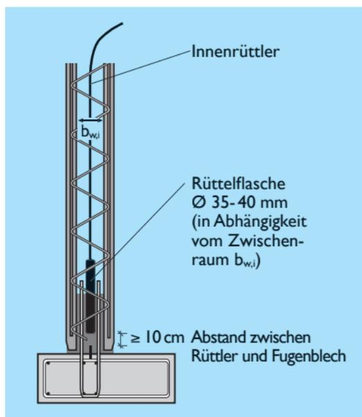
Beim Verdichten ist eine direkte Berührung der einbetonierten Fugenabdichtung mit dem Innenrüttler zu vermeiden.
