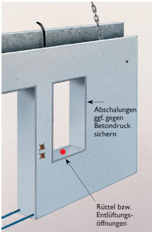
Abschalungen am Wandende oder an Aussparungen sind für den Betondruck in Wandrichtung zu sichern.
