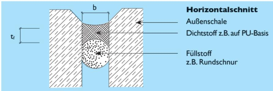
Die Fugen zwischen den Außenschalen sind wie oben gezeigt elastisch nach DIN 18 540 zu schließen. Zu empfehlen sind hier „nicht wassersaugende“ Rundprofile z.B. geschlossenzellige PE Rundschnüre, die mit abgerundeten Werkzeugen vorsichtig in die Fuge eingebracht werden. Nach Einbringen des Füllstoffes werden die Betonflanken mit einem Primer eingestrichen. Der Dichtstoff wird so in die Fuge eingebracht, dass er bündig mit der Innenkante der Dreikantleiste abschließt.
