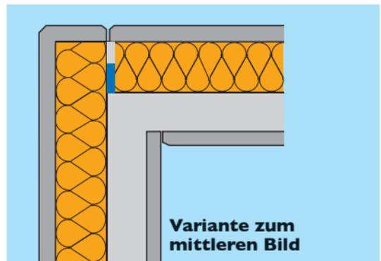
Grate, Schalungsversprünge, etc. an den Fasen sind bauseits vor dem Einbringen der Dichtstoffe nachzuarbeiten.
