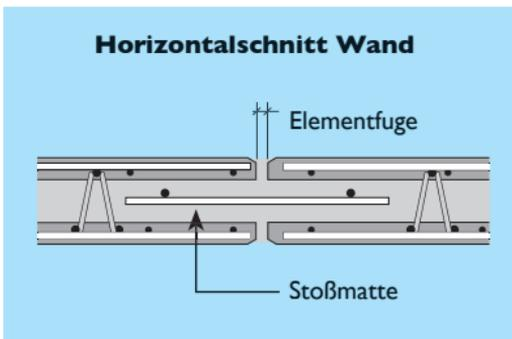
Die ggf. erforderliche Stoß- bzw. Anschlussbewehrung ist laut Statik einzubauen. In der Regel genügt ein Mattenstreifen als Stoßmatte.
