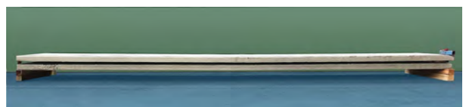
Bild 6 Prüfung zum Kriechverhalten: Versuchsaufbau als Einfeldträger auf Kanthölzern mit 5,40 m Spannweite
