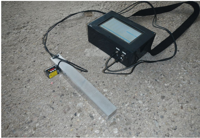
Bild 12 SL-Laser-Profilometer, neues mobiles Messsystem SL-Laser-Profilometer, a new mobile measurement device
