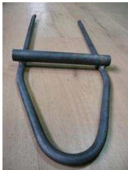
*Der Syspro-Transportanker S3 +glatt besteht aus einem offenen Stahlbügel  $\varnothing$  14 mm mit aufgeschweißtem Querstab  $\varnothing$  25 mm. Die Stahlgüte ist S235JR.*
