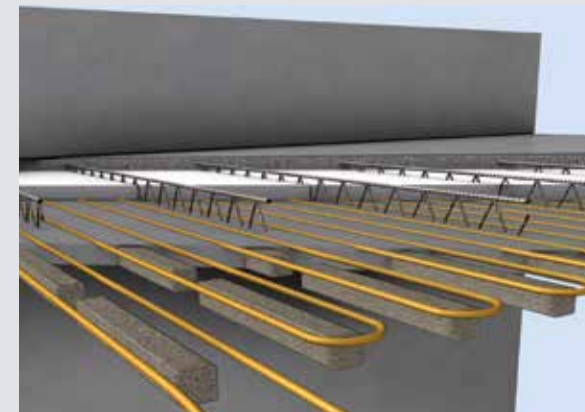
Schematische Darstellung Green-Code®- Audiothermdecke
