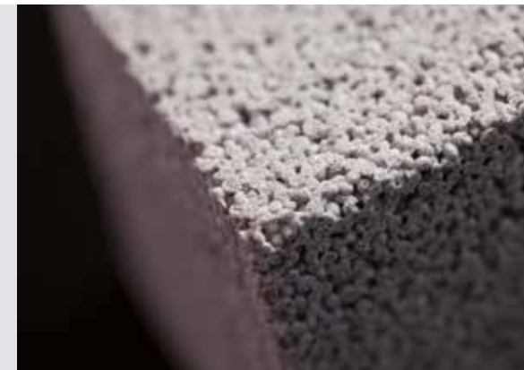
Reapor® Schallabsorber aus gesintertem Recycling-Glas
