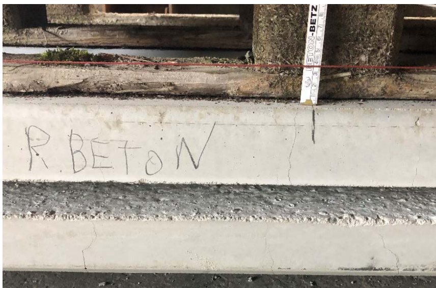
Bild 7: Prüfung zum Kriechverhalten: die in Feldmitte gemessene Durchbiegung nach 7 Wochen Dauerlast von 5 kN.
